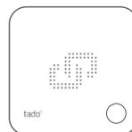
Pokud se spárování nezdaří (E0), zjistěte, jestli je vzdálenost mezi přístroji cca 3 metry. Provedte párování znovu, při čemž tlačítko stisknete a podržte 3 sekundy.
