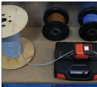
Montážna doska a systémový kufr RM35 pri kompletizácii káblov
