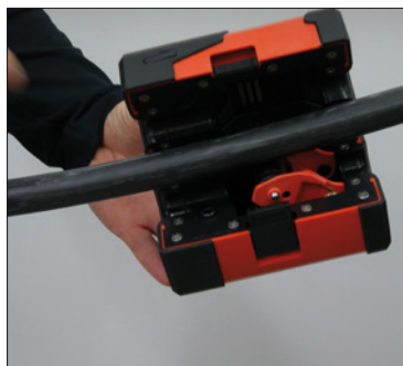
Jednoduché nasadenie kábla do otvárateľného púzdra RM35
