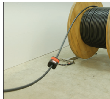
RM35 s odvíjačom RUNPOLIFER 4500 a káblom 1 x 300 mm 2
