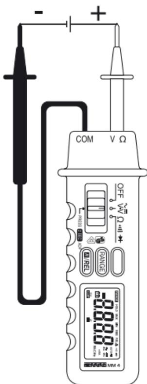
Bild 2: Gleichspannungsmessung
