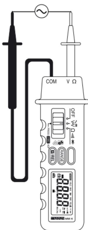
Bild 3: Wechselspannungsmessung
