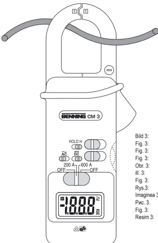
Bild 3: Wechselstrommessung
