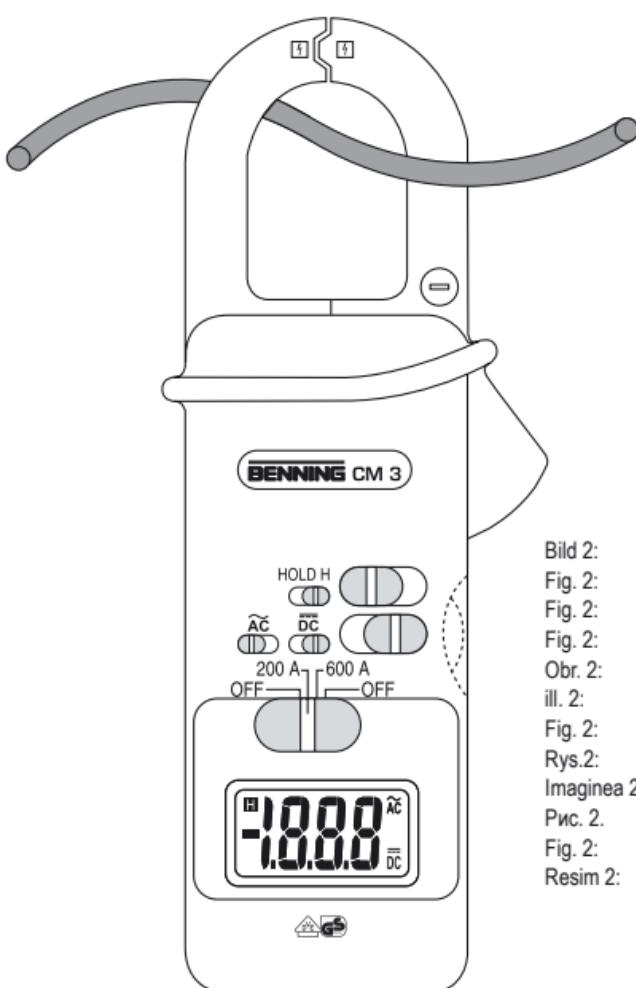
Bild 2: Gleichstrommessung
