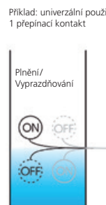
Champ 2 Plovákový spínač s typem výstupu „Plnění/Vyprazdňování“
