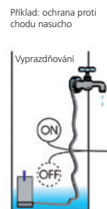
Champ 1L Plovákový spínač s typem výstupu „Vyprazdňování“
