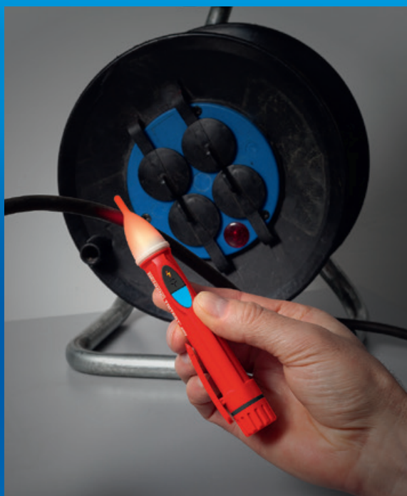
Bezkontaktní hledání přerušení izolovaných kabelů a vedení, která jsou pod napětím
